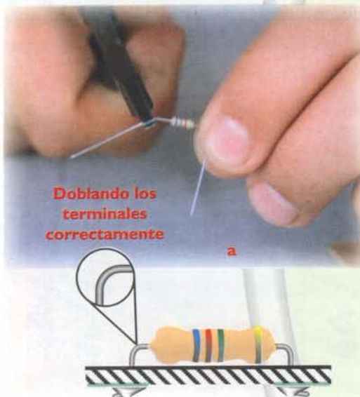
Figura 6.9. Montaje de las resistencias en un circuito impreso
